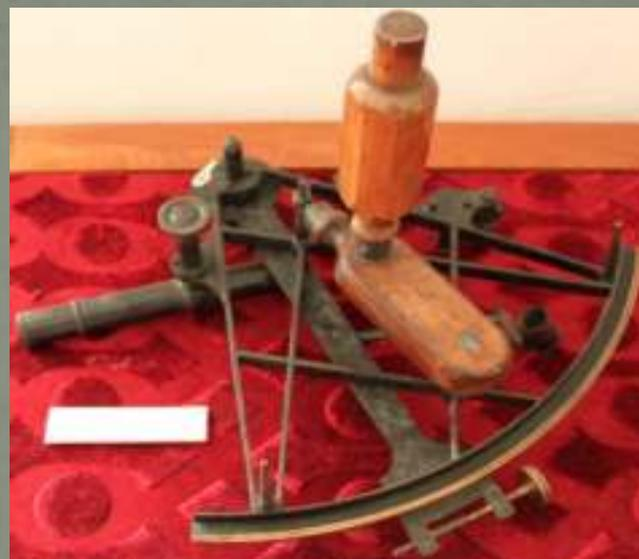
Servia para tirar a posição (em latitude e longitude) do navio ao observar o sol ao meio dia ou as estrelas ao principio da noite. O Sextante tem pequeno espelho que facilita a observação a  $45^{\circ}$  ou a  $90^{\circ}$
